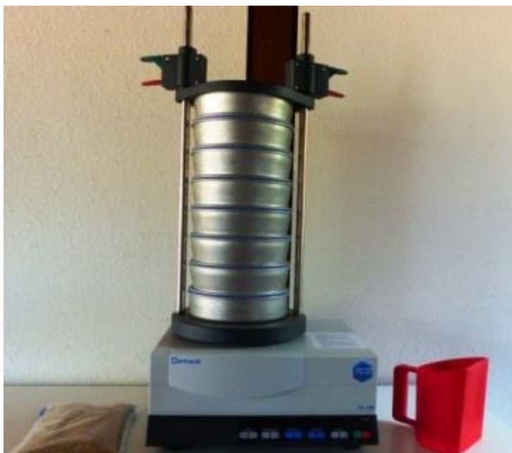
Abb. 17: Siebanalysegerät zur Bestimmung der Futterstruktur
